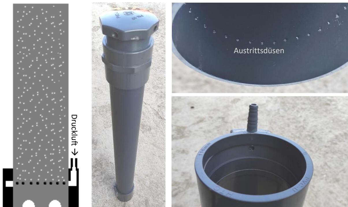
**Abbildung 9: Technischer Luftheber aus handelsüblichen PVC-U Rohren: links Skizze, mitte Schraubdeckel mit Austrittsöffnungen, rechts oben Austrittsdüsen, rechts unten Anschluss für Druckluftleitung und Ringkanal**
